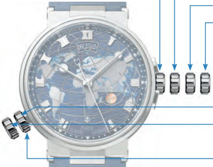
I - Заводная головка для завода часов, установки времени и изменения даты
