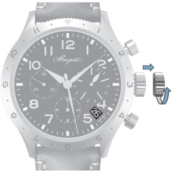
リューズをポジション **X2** 引き出します。リューズを上方向(①)に回し、窓に正しい日付を表示させます。それからリューズをポジション **X1** に押し込みます。
