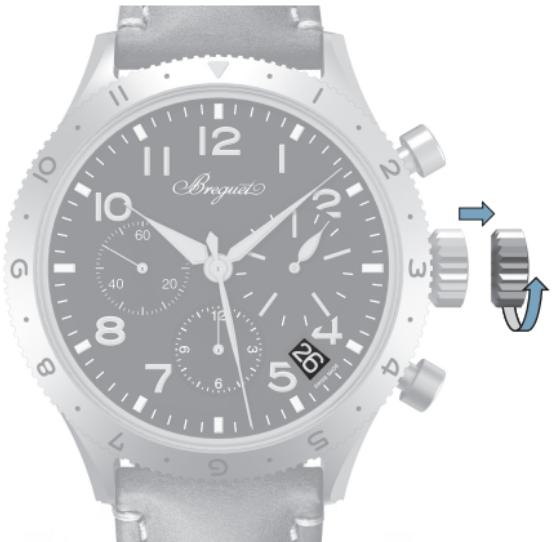
将表冠拉至**X2**档位。朝上旋转表冠①直至显示窗内出现正确的日期。然后再将表冠推回至**X1**档位。
