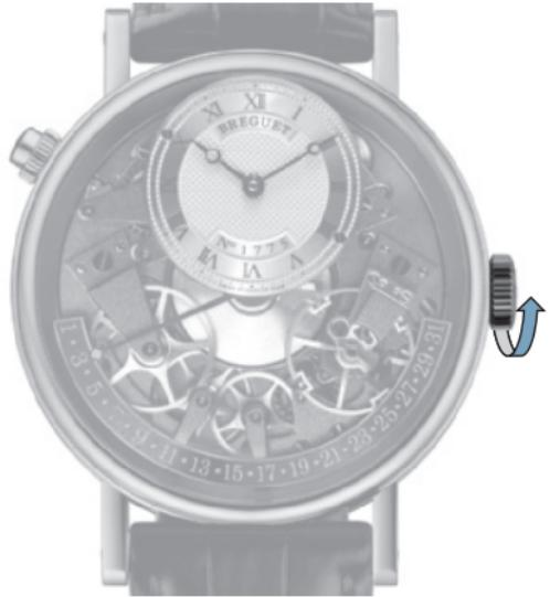
錶冠處於**X1**位置。這位置允許您為機芯手動上鏈。當您要使用原本停止走動的腕錶時，在進行任何操作之前，請您先為腕錶進行手動上鏈，將錶冠朝上旋轉30圈①。接著，佩戴在手腕上的腕錶將自動上鏈，直至動力儲備完全充足的狀態。如果上滿鏈之後沒有佩戴，腕錶將在大約50個小時後停止走時。
