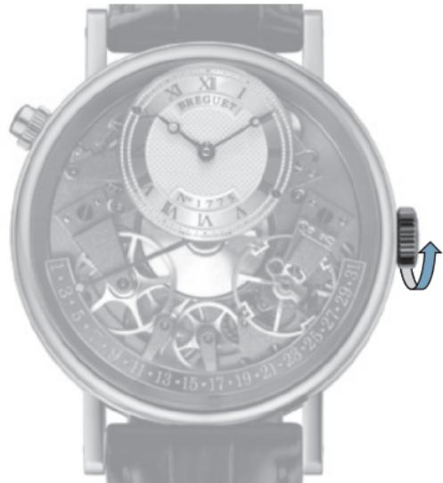
当表冠**X1**位于**X1**档位时，该档位表示您可为机芯手动上链。若腕表已停止走时，在进行任何操作之前，要先为腕表手动上链，将表冠向上旋转30圈①。佩戴在手腕上后腕表则会自动上链并最终自动上到满链状态。若没有佩戴，满链状态下的腕表将于约50个小时后停止走时。
