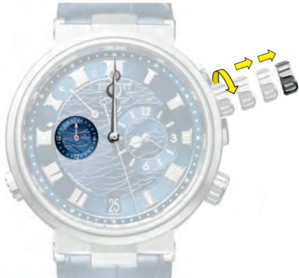
Die Krone **X** wieder in Position **X2** drücken, dann in Position **X3** ziehen und den Stundenzeiger der örtlichen Zeitzone durch Drehen der Krone nach oben (2) von einer Stunde zur nächsten springen lassen, bis das Datum im Fenster **D** umspringt.
