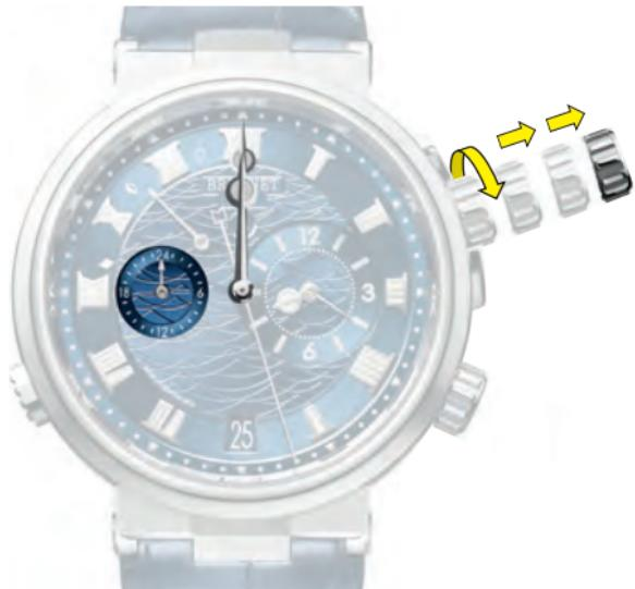
リューズ **X** をポジション **X2** に押し込み、次にポジション **X3** に引き出して、リューズ **X** を時計廻りに(①)回しながらローカルタイムの針 **H12** を1時間ずつ、窓 **D** の日付表示が変わるまで進めます。
