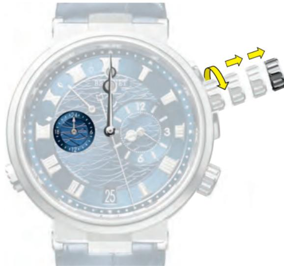
Repousser la couronne **X** en position **X2**, puis la tirer en position **X3** et faire sauter l'aiguille des heures du fuseau local **H12** d'heure en heure en tournant le couronne vers le haut (☞) jusqu'à ce que change la date affichée dans le guichet **D**.
