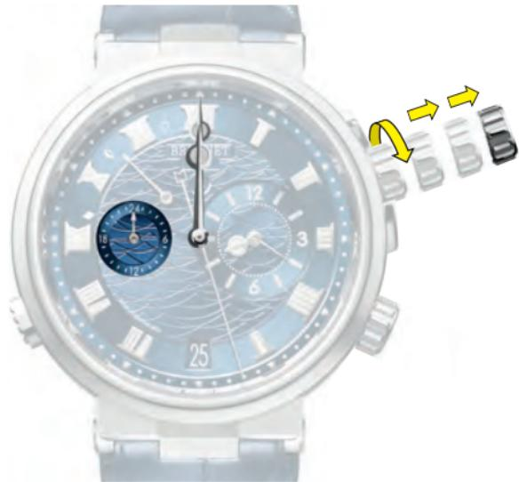
Установите заводную головку **X** обратно в положение **X2**, а затем оттяните ее в положение **X3** и переводите стрелку местного часового пояса **H12** час за часом, вращая заводную головку вверх (🕒), пока не изменится дата в окошке **D**.
